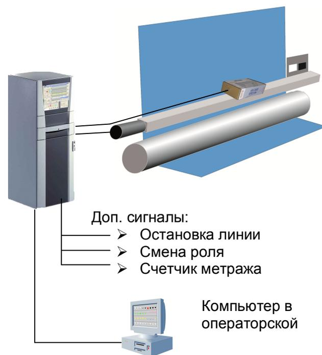
Рисунок 3: On-Line система контроля цвета
